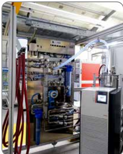
Специальное решение PRESTO A45t как часть установки для контроля аккумуляторных батарей
