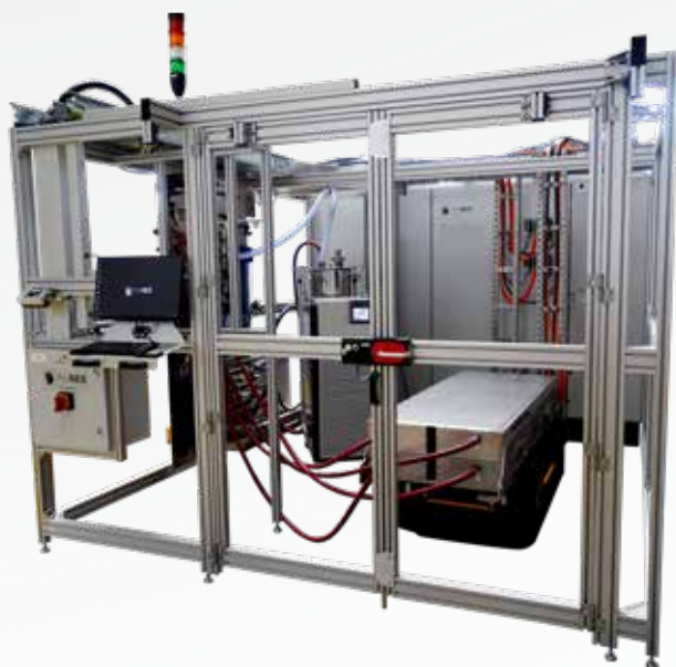
Комплексное решение для контроля аккумуляторных батарей Battery Inspector от ProNES со встроенной системой термостатирования PRESTO
