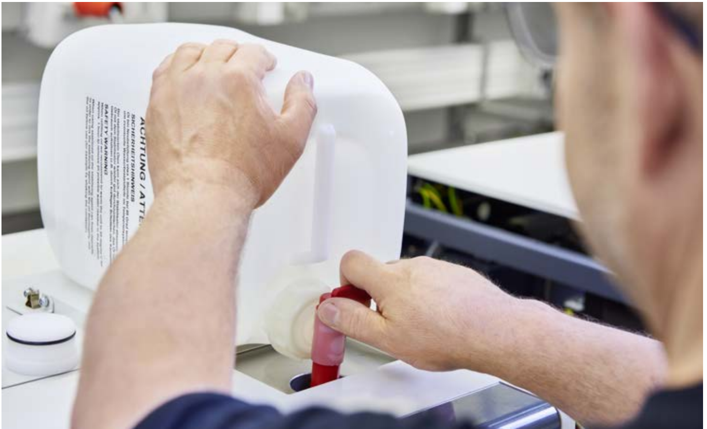
Заливное отверстие следует располагать так, чтобы заполнение было максимально простым и чистым, а пролитая жидкость не попадала внутрь устройства.
