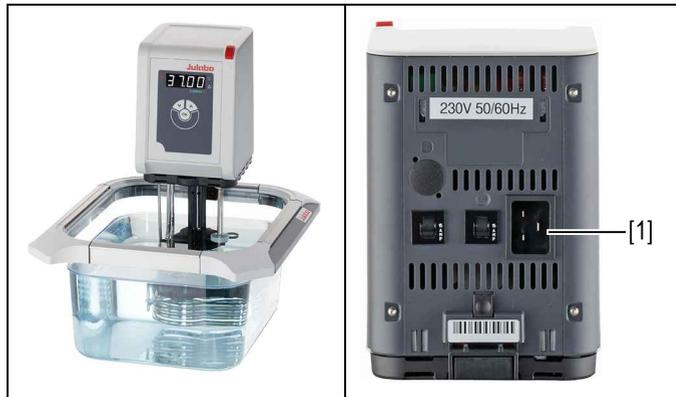
1. Conecte el cable de conexión a la red de la parte trasera del termostato en la toma de conexión [1].
