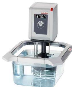
Termostato con cubeta transparente. Ejemplo: CORIO C-BT9.
