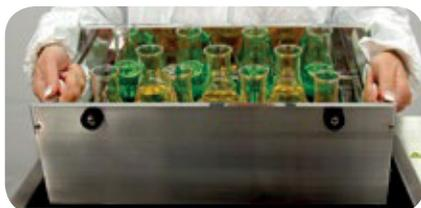
Mit dem herausnehmbaren Schüttelwagen vermeiden Sie direkten Kontakt mit der Badflüssigkeit und Sie können die Tablette bequem außerhalb des Bades bestücken.
