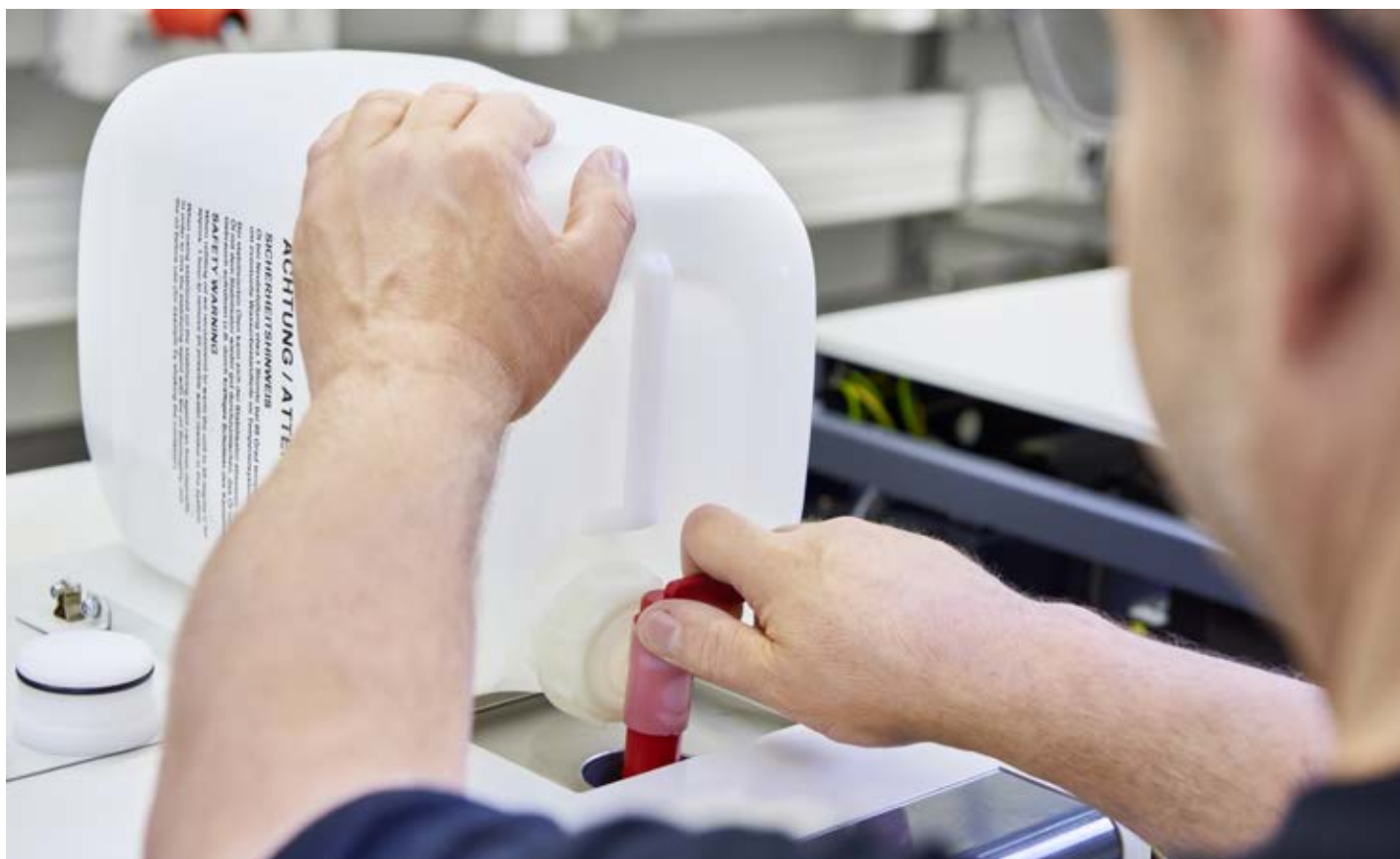
El puerto de llenado debe ubicarse de manera que el relleno sea lo más fácil y limpio posible, y que no entre ningún fluido vertido en la unidad.
