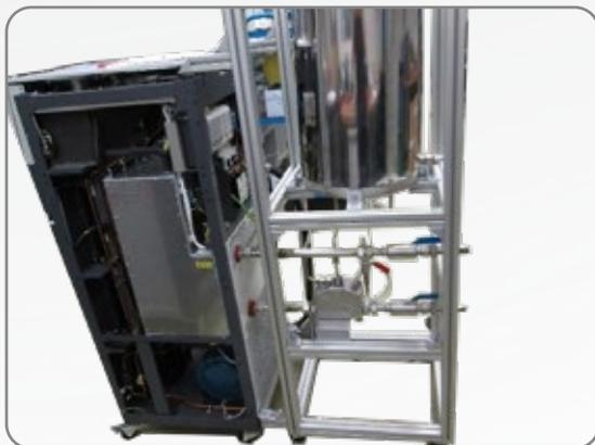
o rack especial com tanque adicional, conectado ao PRESTO
