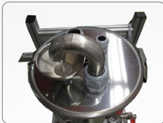
sutilezas técnicas, como um filtro na entrada, reduzem a quantidade de sujeira que entra no sistema geral e, assim, reduzem os intervalos de manutenção e trocas de fluido, entre outras coisas
