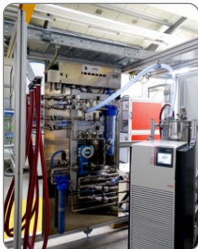
La solución especial con el termostato PRESTO A45t como parte del „batterieinspektor“
