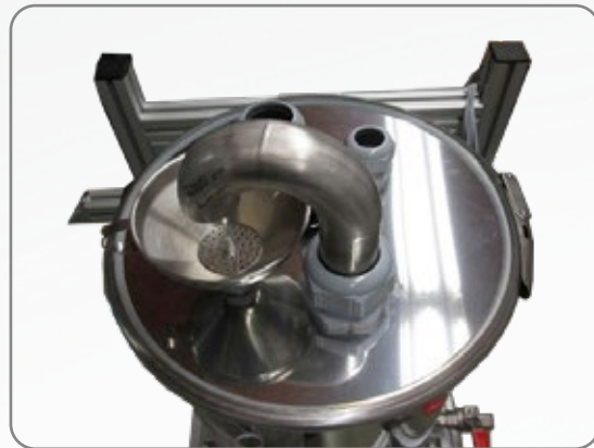
Los finos detalles técnicos, como un filtro instalado en el punto de admisión, impiden la entrada de suciedad en todo el sistema y, con ello, reducen las paradas de mantenimiento y los cambios de medios, entre otras interrupciones
