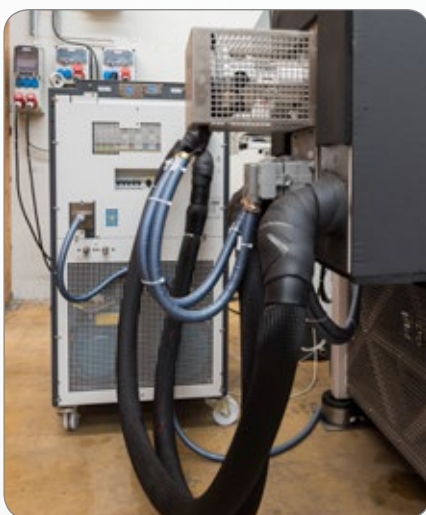
Fig. 5: moteur du ventilateur placé à l'extérieur du boîtier
