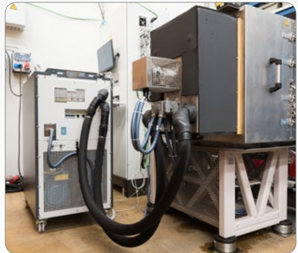
Fig. 8: Camera di test universale nella quale gli oggetti vengono esposti a temperature ambientali ed estreme simulate
