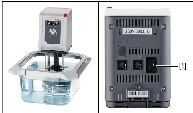
1. Inserire il cavo di alimentazione CA nella presa CA posta sul retro del termostato [1].
