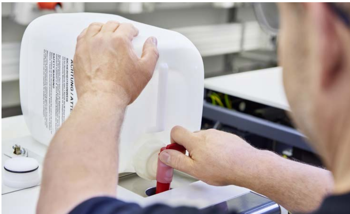
Il foro di riempimento deve essere posizionato in modo che il riempimento sia il più semplice e pulito possibile e che nessun fluido fuoriuscito penetri nell'unità.
