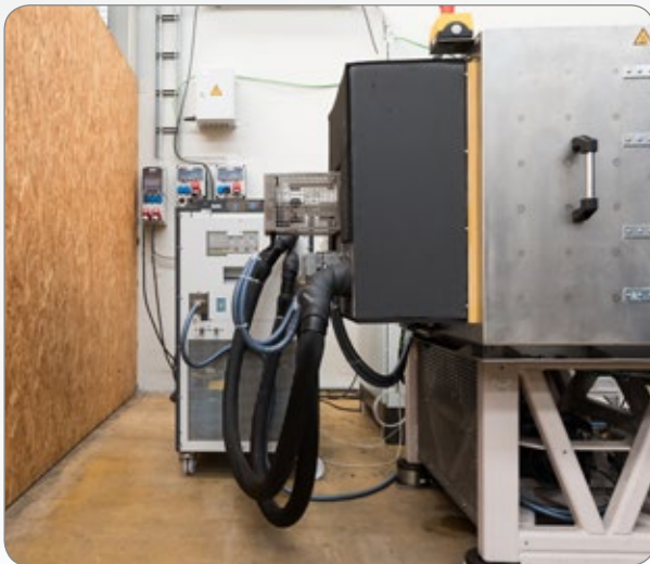
Fig. 7: Carcaça isolada do transmissor de calor.
