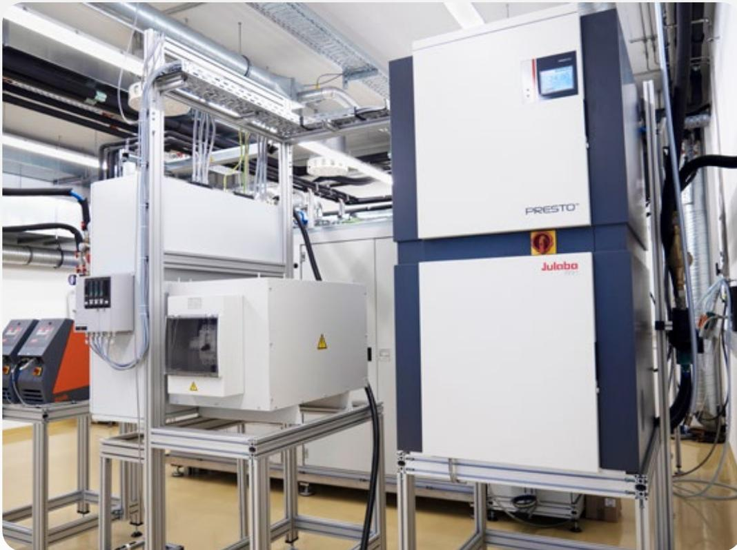
Además, los dispositivos de la serie PRESTO W91 ofrecen una reserva de potencia suficiente para, en casos especiales, poder trabajar también en un rango de temperatura de  $-91\text{ °C}$  como temperatura mínima y de  $+250\text{ °C}$  como temperatura máxima.
