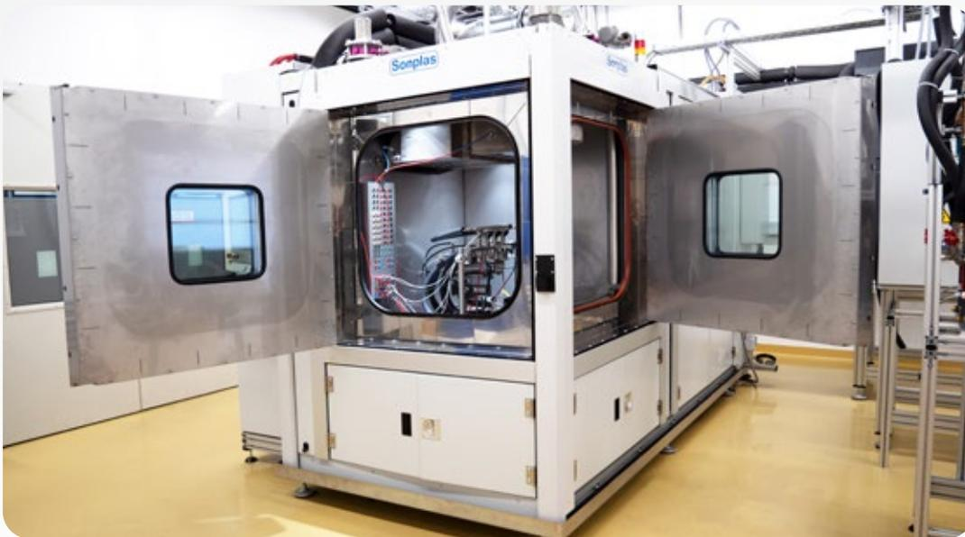
Este concepto, combinado con otras medidas en relación con la protección contra explosiones, hace que las cámaras térmicas de Sonplas resulten ideales para realizar ensayos con productos de los que se espera la liberación de sustancias explosivas. Tal liberación puede ocurrir al utilizar combustibles convencionales, bien sean biológicos o sintéticos, así como al utilizar hidrógeno, metano u otras mezclas y gases explosivos, por ejemplo, los provenientes de baterías.
