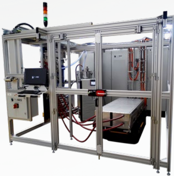
Komplettlösung ProNES-„batterieinspektor“ mit integriertem PRESTO Temperiersystem
