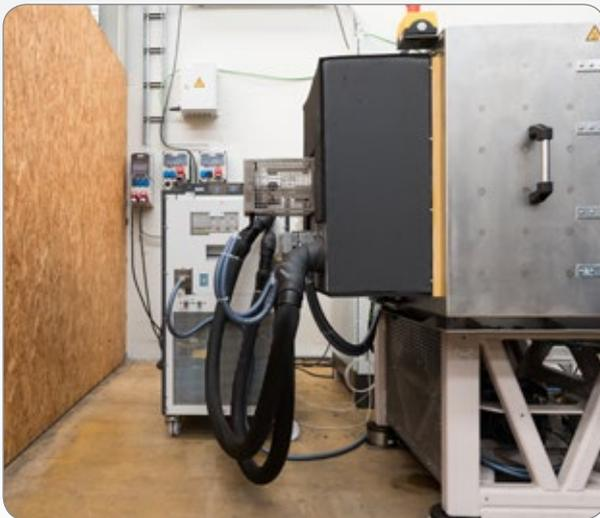
Abb. 7: Isoliertes Gehäuse des Wärmeübertragers.
