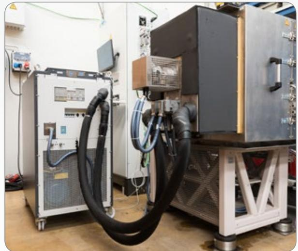
Abb. 8: Universelle Umhausung in der Prüflinge simulierten Umgebungs- und Extremtemperaturen ausgesetzt werden
