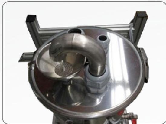
Les subtilités techniques, comme un filtre à l'entrée, réduisent la pénétration de saletés dans l'ensemble du système et réduisent ainsi, entre autres, les intervalles de maintenance et le changement de produit
